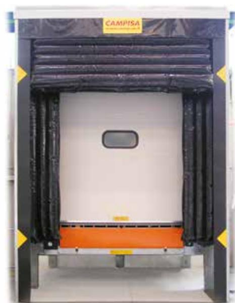
Adapté aux environnements d'étanchéité à des températures très différentes, composé de trois coussins gonflables qui compriment légèrement le toit et les côtés du fourgon, assurant une isolation maximale.
